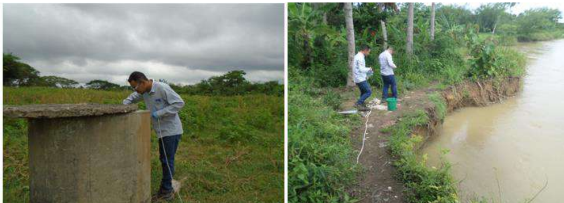
Ilustración 38. Toma de muestras Pozo de Agua Subterránea Lórica. Vs Toma de muestras Agua Superficial (San Jorge). Fuente: Laboratorio de Aguas del Caribe, 06/07/2023
